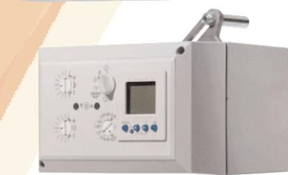
Die Regler-Baureihe WAR 3 ME (H) eignet sich besonders für den Einsatz in der Heizungs und Klimatechnik und dient zur witterungsgeführten Regelungen von Mischern in Warmwasserheizungen. Durch den integrierten Stellmotor lässt sich die WAR 3 ME H / WAR 3 ME mit dem entsprechenden Bausatz auf beliebige Mischer mit Nennweiten ab DN 15 bis DN 100 montieren. Sie zeichnet sich durch eine kompakte und robuste Bauform aus.
