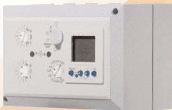
Der Heizungsregler WAR 3 ist eine witterungsgeführte 3-Punkt Regelung zur Vorlauftemperatursteuerung bei motorischer Mischerverstellung. Bei Bedarf kann ein Raumtemperaturfühler FBD angeschlossen werden.
